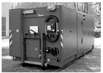
Der Container erweitert den Gefahrgutzug um die Komponente "Dekontamination". In dem Abrollbehälter können kontaminierte Einsatzkräfte nach dem Einsatz gereinigt werden.
