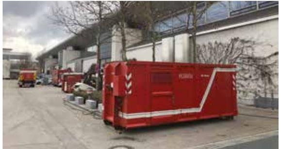
Der AB-Strom beinhaltet ein kräftiges mit Diesel betriebenes Stromaggregat, welches bis zu 150 kW Leistung bringt. Damit man sich was darunter vorstellen kann, das sind 1.500 Glühlampen mit 100 Watt. Neben dem Stromerzeuger sind noch einige hundert Meter Kabel für verschiedene Stromstärken, Baustromverteiler und Unterverteilungen verladen.
