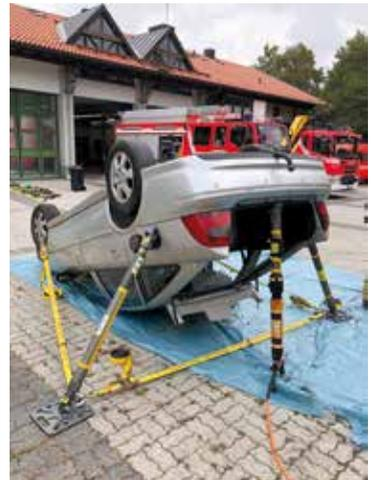
von Gräben oder Baugruben. Die Stützen können mittels Druckluft beim Heben nachgeführt werden. Somit bleiben die Stützen an der Last, ohne dass jemand sie halten oder bewegen muss. Zum Sichern muss nur kurz eine Mutter an dem Gewinde angezogen werden. Dies erhöht deutlich die Sicherheit der ehrenamtlichen Einsatzkräfte, da sich niemand im Gefahrenbereich der Last aufhalten muss. Während der Übung haben wir uns vor allem dem sicheren Unterbauen und Abstützen eines verunfallten PKWs gewidmet.
