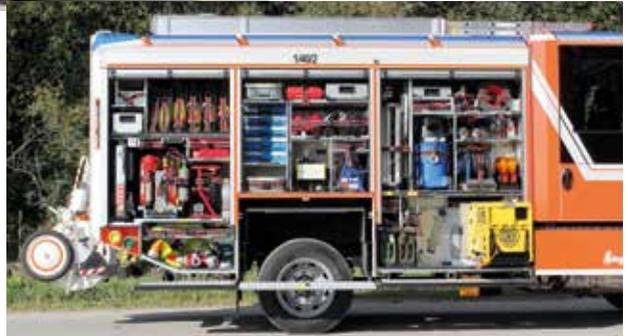
für die Schiebleiter, Unterbodenbeleuchtung, Einsatzstellschaltung von RKL und Umfeld Beleuchtung, Bullhorn, 360 Grad Kamera, LARDIS Funkbedienung und Einsatzdaten Navigation, Tablet mit Einsatzplänen und Alarmdaten, Smartphone, PA Halterung im GF Sitz integriert und eine Pump & Roll Funktion.
